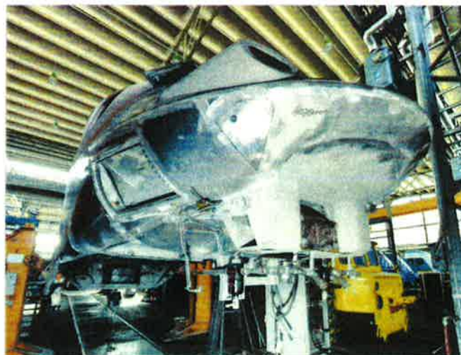
Aluminium-Leichtbau war in den frühen 1970er-Jahren beim ET 403 angesagt.
